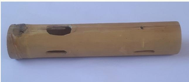
30.00 cm de largo y 6.00 cm de diámetro. Puede tener mayor o menor dimensiones dependiendo del material disponible. Preferiblemente seco y curado. Tiene las ranuras para insertar las alas delanteras y la trasera.
