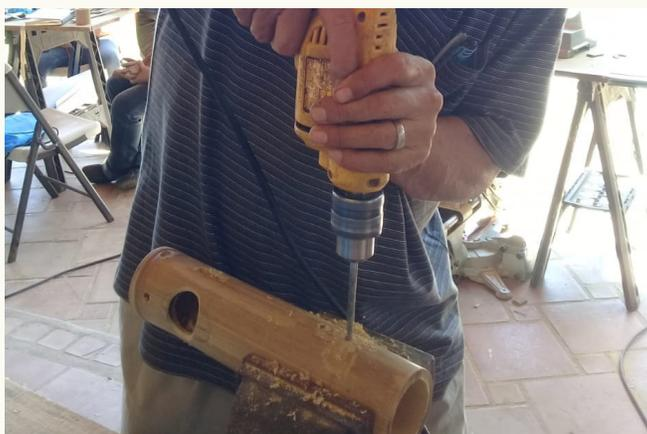
En la parte delantera del cilindro se perfora el centro con broca de 1/2", se introduce un espiche de 1/2" y se coloca la pega.
