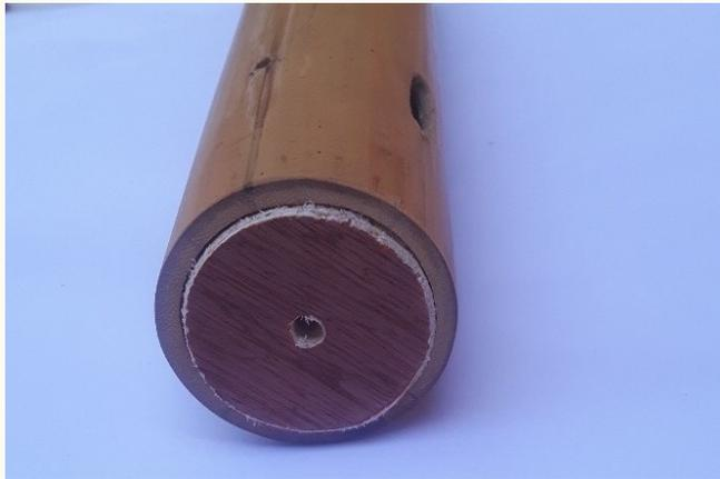
El tapón trasero del fuselaje tiene 5.0 cm, con uno de grosor. El diámetro será conforme el del fuselaje.
