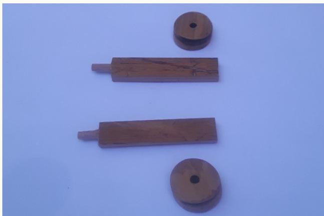
Las piezas largas son los soportes de las ruedas delanteras que a su vez se fijan en el ala inferior. Los soportes tienen 10.0 cm de largo, 2.0 cm de ancho y uno de grosor.
